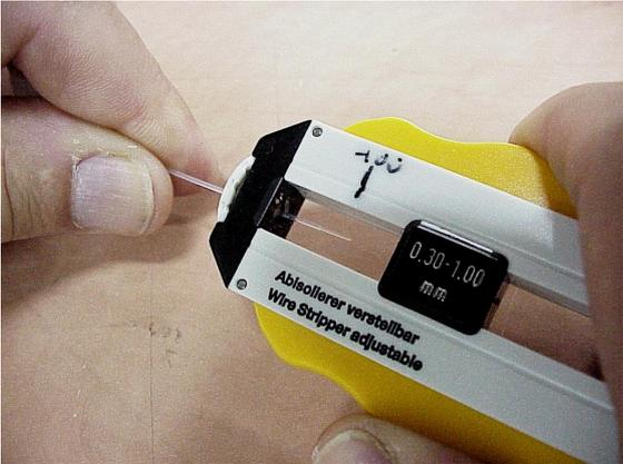
**FIG 26.4 - FIBER AFTER STRIPPING PLASTIC CLADDING**
